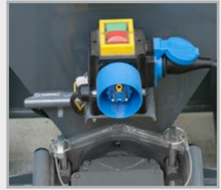
Praktischer 230 V Anschluss und sparsamer, geräuscharmer Elektromotor
