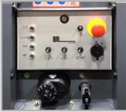
Mit dem übersichtlichen Bedientableau lässt sich die Maschine bedienerfreundlich und CE-konform steuern. Förderleistung und Wasserdosierung sind stufenlos einstellbar.
