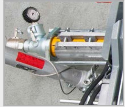
Im Serienumfang enthalten, die leistungsstarke Schneckenpumpe 2L6 mit M 50 Druckstutzen. Je nach gewünschter Fördermenge und Materialbeschaffenheit können Sie Baustellenmischungen mit bis zu 6 mm Körnung verarbeiten.
