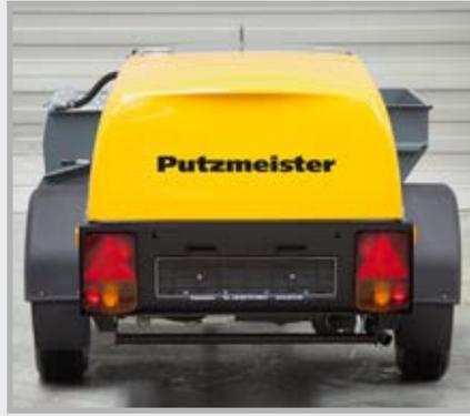
Die extrem leichte Kunststoffhaube ist besonders robust und optimal vor Korrosion geschützt.
