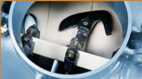
Gran tanque de mezcla con mezcladores resistentes al desgaste
