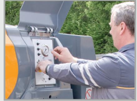
Die P 718 bedienen Sie komplett von einer Seite aus, z.B. die stufenlose Einstellung der Fördermenge oder der Motordrehzahl
